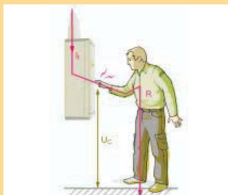
La tension limite représente la valeur du seuil sous lequel il n'y a pas de risque d'électrocution. En règle générale, la tension nominale des installations est supérieure à la tension limite (50 V). Pour qu'il n'y ait aucun danger, il faut que la tension de contact  $U_c$  présumée reste inférieure à la tension limite.
