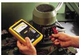
Contrôle d'isolement d'enroulements de moteurs électriques
