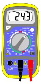
Le sélecteur de calibre a été placé sur le calibre 200 Vac. La mesure est de 24,3 Vac. Le calibre est ici correct.
