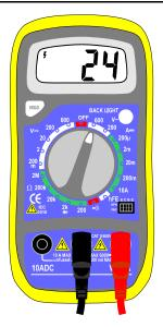
L'afficheur indique 24 Vac, le calibre immédiatement inférieur est de 200 Vac. Il est nécessaire de descendre d'un calibre.
